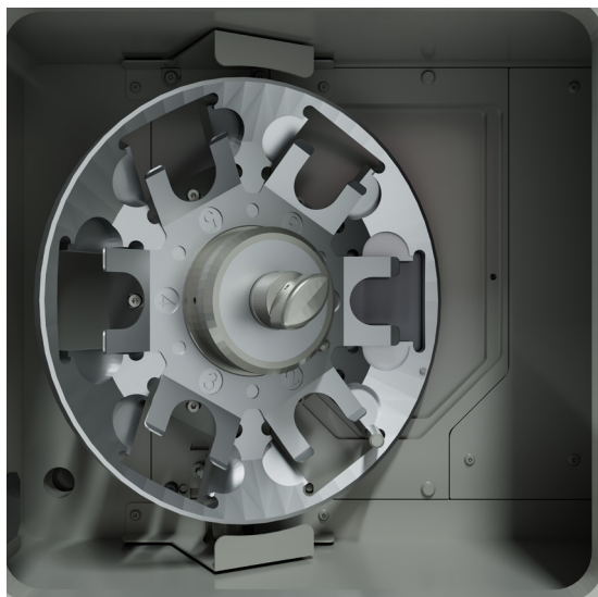
試料ホルダー 6試料ターレット用 (左)、1試料ホルダー用 (右)
