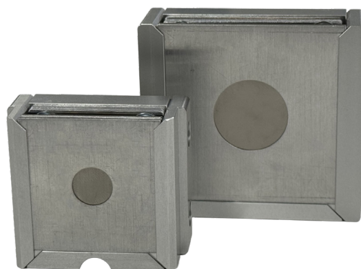
試料ホルダー 6試料ターレット用 (左)、1試料ホルダー用 (右)
