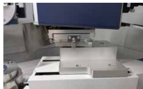
カメラ長は電動で駆動し、ソフトウェア上で変更可能
