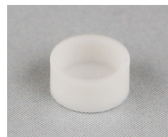
④ Alumina pan \phi 5 \times 2.5 mm
