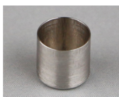
⑦ Pt pan \phi 5 \times 5 mm
