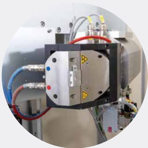
225 kVの高電圧高出力マイクロフォーカスX線源
