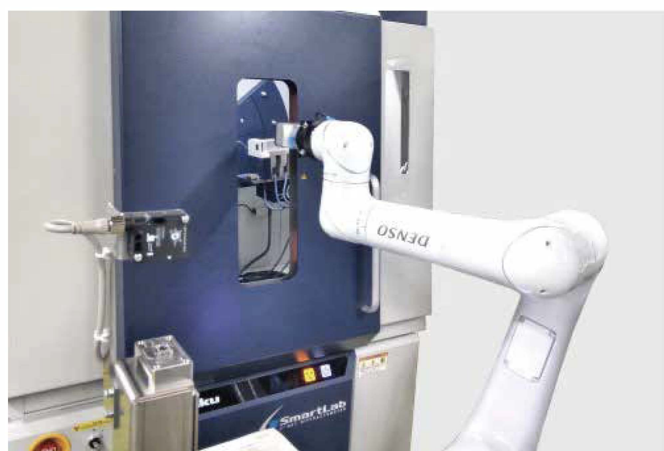
SmartLab の自動開閉機構 ロボットアームの装置内アクセス対応
