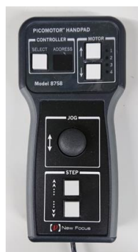
コリメーター調整ユニット コントローラー
