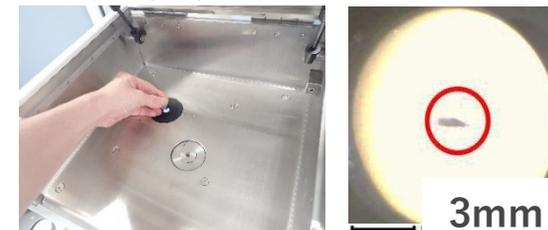
装置に置くだけ，内蔵カメラでポイント指定
