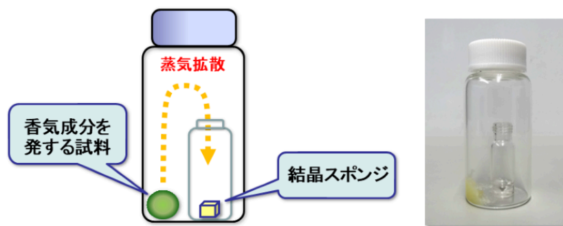
図1: 結晶スポンジへの香気成分の包接
