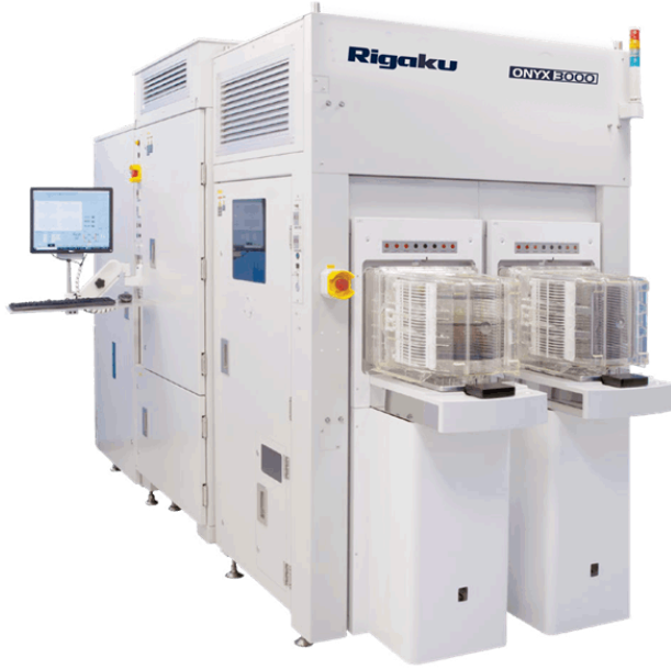
図1： ONYX 3000によるインライン非破壊ウェーハ検査および計測 X線源および光学系には、単色X線ビームモジュールCOLORS-Wを適用している（図2）。
