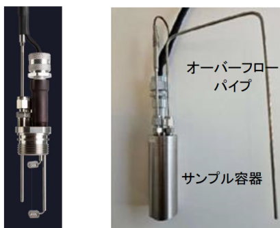
(左)THWセンサー | (右)サンプルのセッティング
