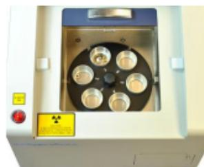
図1 自動試料交換機
