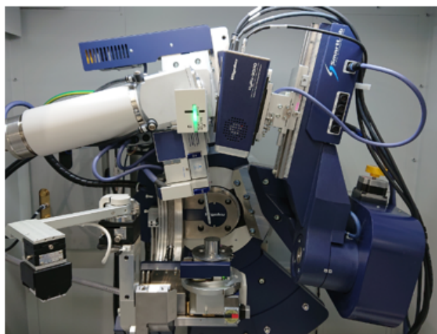
図2 ポイント線源・コリメーター・2D露光測定による残留応力測定光学系
