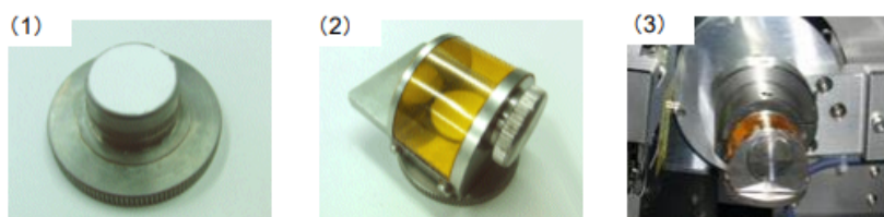
図1 汎用雰囲気セパレーターを用いた試料調製
