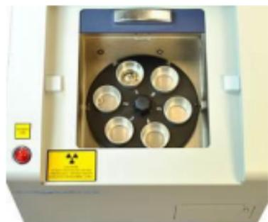
図1 自動試料交換機
