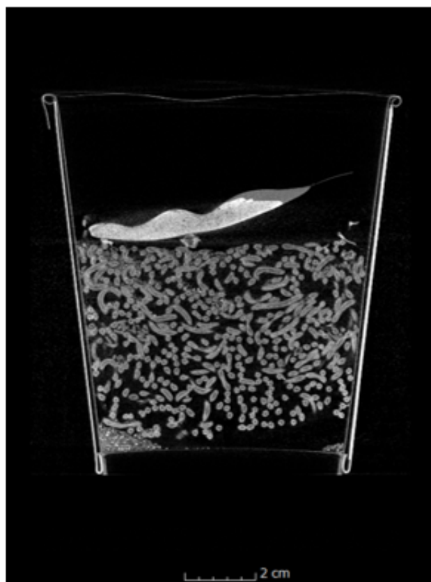
図3 カップラーメンのCT断層画像
