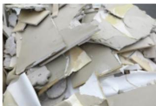
近年廃石膏ボードの再利用が進んでおり、そのガイドライン<sup>1)</sup>には有害金属元素の溶出の基準と試験法が定められています。公定法の溶出試験は手順や分析が煩雑なため、含有量による回収物の選別や溶出試験前のスクリーニング分析として、廃石膏ボードを粉末状態で測定可能な蛍光X線分析法が有効です。ここでは、エネルギー分散型蛍光X線分析装置 NEXシリーズ NEX DEによる石膏中の微量有害元素の分析例をご紹介します。
