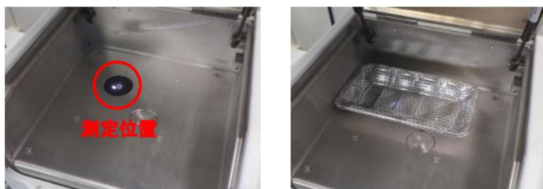
図2 NEX DE 試料室中のプラスチックトレイ試料
