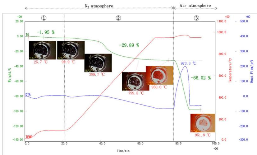
石炭の試料観察TG-DTAの測定結果
