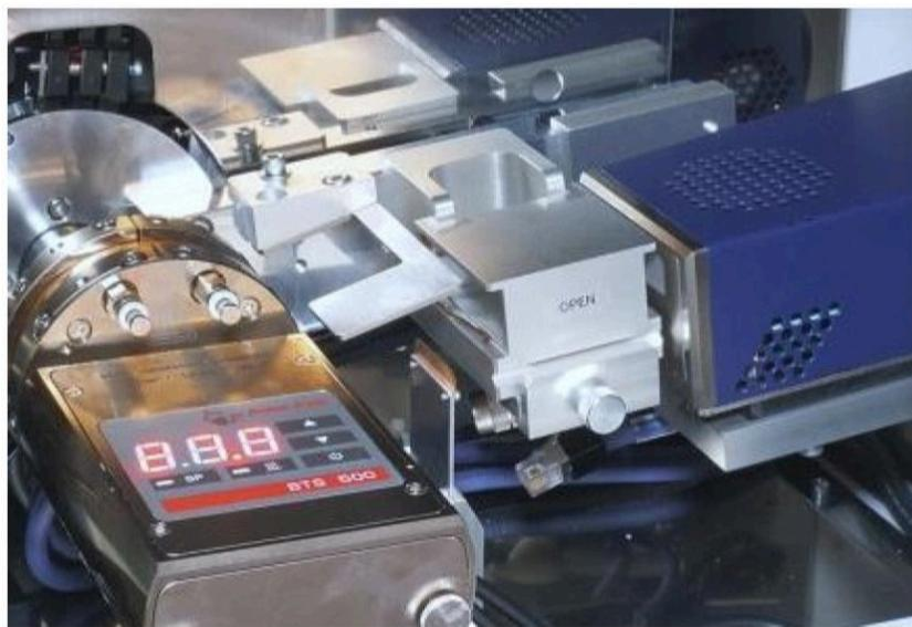
図1 HyPix-400 MFとBTS 500をセットしたMiniFlex内部
