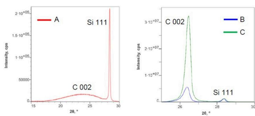
図1 カーボン試料A, B, CのX線回折プロファイル
